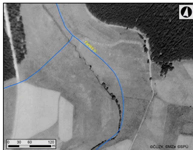
Obr. 25 Příklad narovnění meandrujícího toku Farského potoka v rámci provedeného odvodnění (stav v 50. letech 20. století, modře znázorněn současný narovnaný tok potoka)
