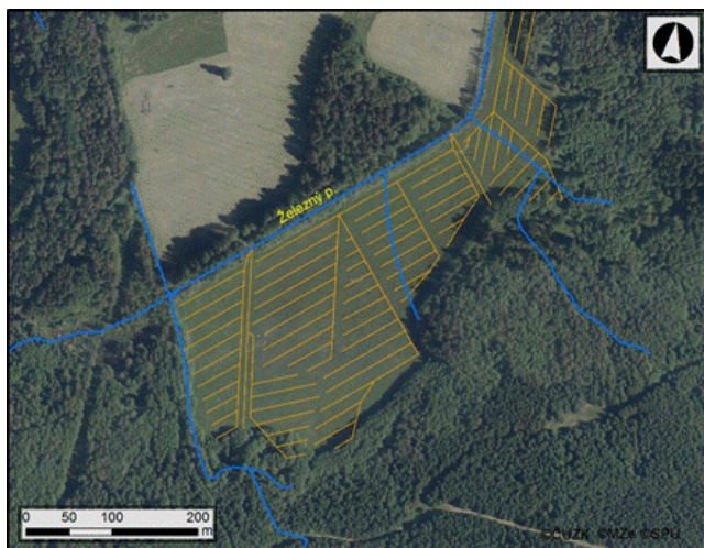
Obr. 24 Ukázka systému drénů a regulace toků na lokalitě Železná u Smolova (okres Domažlice)
