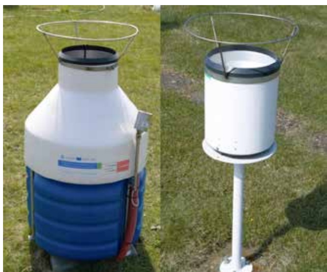
Obr. 47 Měření srážek váhovým (vlevo) a člunkovým srážkoměrem (vpravo)
