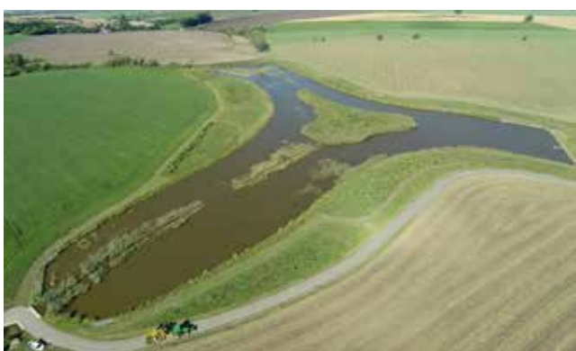
Obr. 113 Ukázka realizace vodní nádrže se stálým nadržáním
