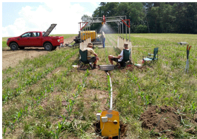
Obr. 32 Ukázka ze simulace polním simulátorem deště
