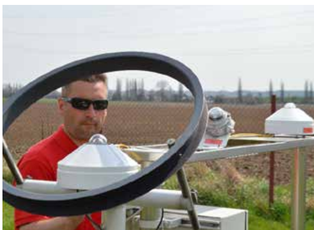
Obr. 49 Měření slunečního záření pyranometry kdy vlevo s krytem je pro měření difúzního slunečního záření, vpravo pro měření globálního (přímého + difúzního) záření a slunoměrem (uprostřed) pro počet hodin slunečního svitu
