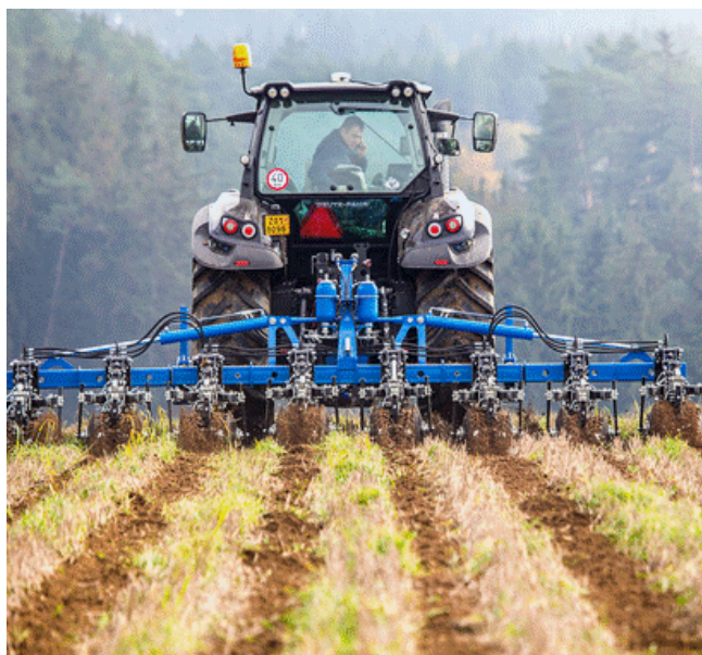
Obr. 33 Pásové zpracování půdy strojem ECO-Tiller
