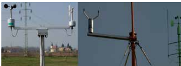
Obr. 48 Měření rychlosti větru miskovým a ultrasonickým anemometrem
